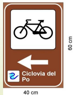
Fig 3: Cartello per avviare a itinerario ciclopedonale generico ottenuto da modifiche delle figure 360 - 363 art 136 DPR 495/92
