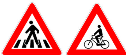
Figura II 13-14 Attraversamento pedonale e attraversamento ciclabile in extraurbano o su strade urbane con limite superiore a 50 km/h
